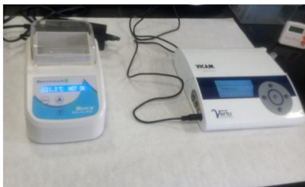
Figura 4. Placa de incubación Benchmark (izquierda) y equipo de lectura VERTU (derecha).
