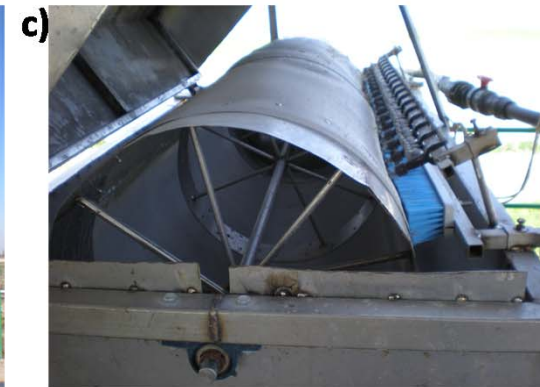
a) Tamiz estático en una granja de vacuno; b) y c) tamices rotativos.
