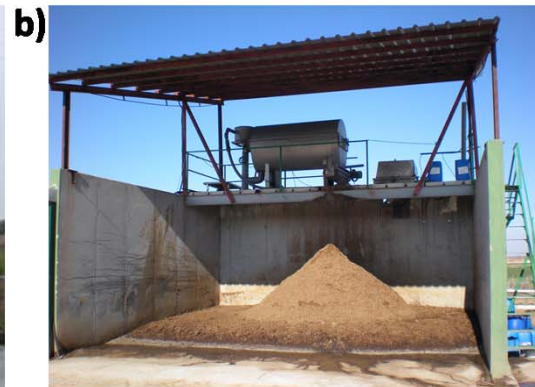
a) Tamiz estático en una granja de vacuno; b) y c) tamices rotativos.
