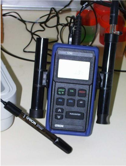
← Conductímetro de campo
