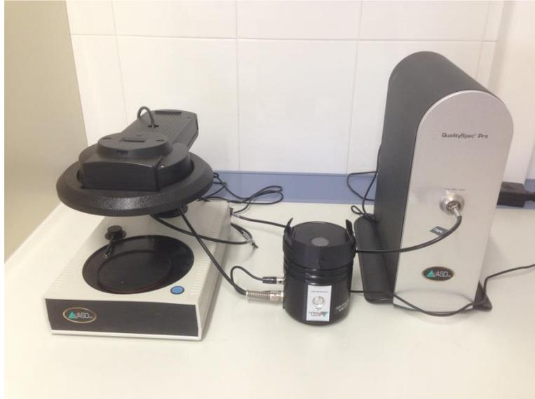
**Figura 7.** Equipo Vis/NIR QualitySpec Pro 2600
