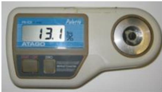
Figura 10. Refractómetro digital ATAGO PR-101
