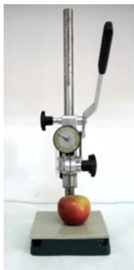
Figura 11. Penetrómetro Fruit Pressure Tester FT32
