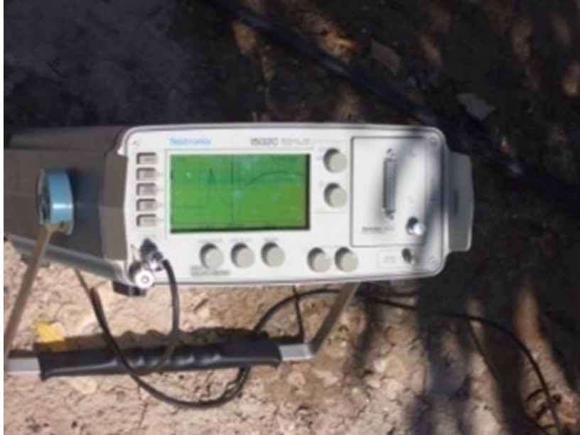
Fotografía 4.5. Equipo Time Domain Reflectometry (TDR). Model 1502C, Tektronix Inc., OR. (Fuente propia).
