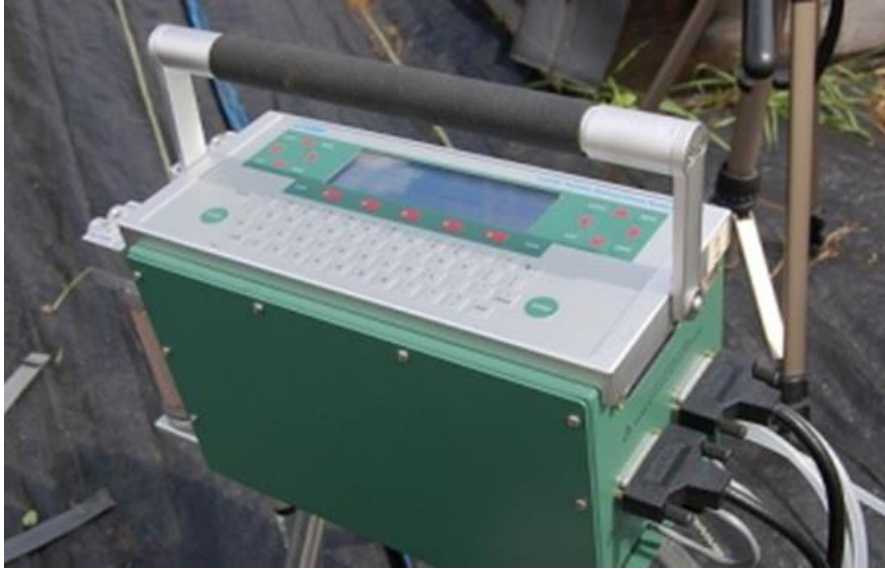
Fotografía 4.4. Sistema portátil para medida de fotosíntesis LI-6400, Li-Cor, Lincoln, NE, USA (Fuente propia).
