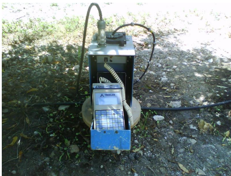
Fotografía 4.6. Sonda de neutrones. Model 4300, Troxler Electronic Laboratories Inc., NC (Fuente propia).
