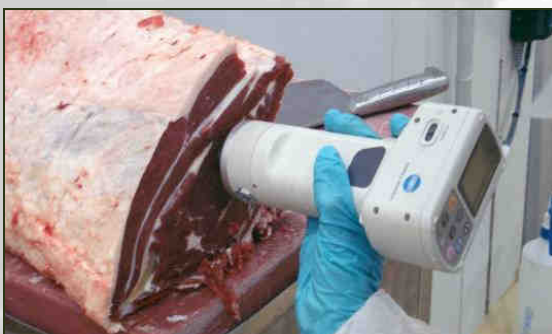
Foto 8. Medición del color de la carne con un colorímetro portátil.
