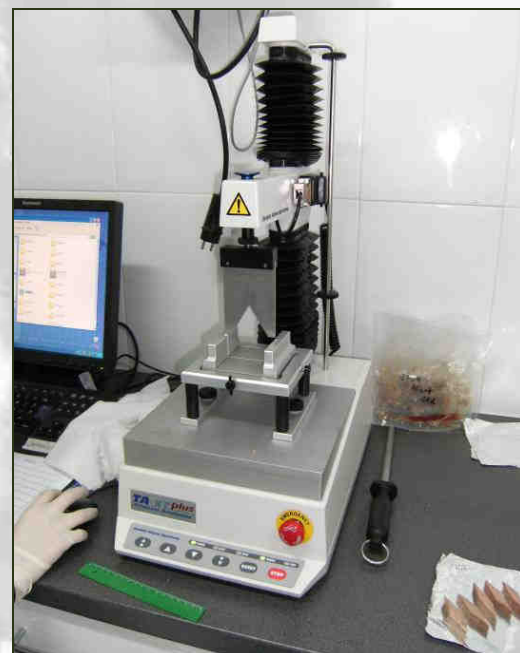
Foto 9. Determinación de la resistencia al corte (dureza) con un texturómetro equipado con una sonda de corte.
