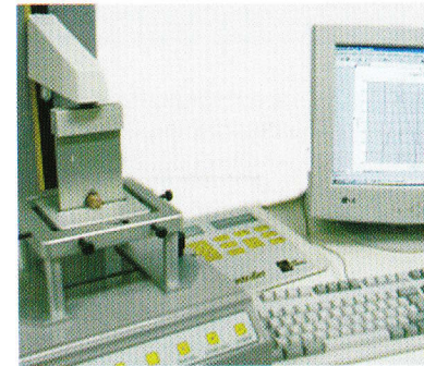
Figura 19. Análisis instrumental de la textura de la carne
