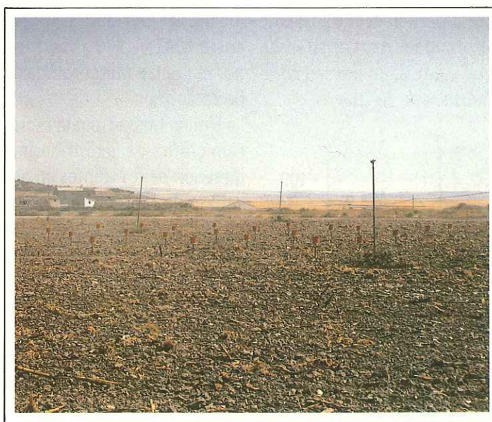
Cuadrícula de pluviómetros en un sector de riego por aspersión fija en la parcela experimental de riegos de Valfarta (Huesca) de la Diputación General de Aragón.
