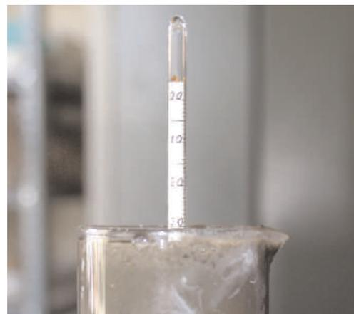
**Figura 4. Vista del densímetro utilizado en las muestras de purín**
