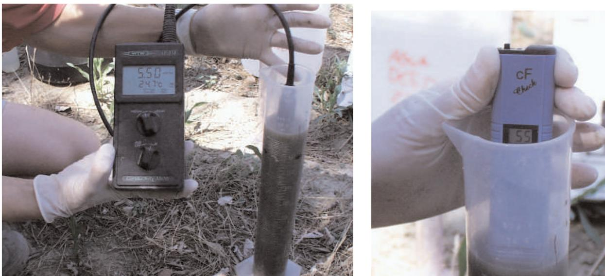
**Figura 5. Vista del conductímetro de campo portátil (izqda) y del conductímetro de bolsillo (dcha) utilizado en las mediciones**
