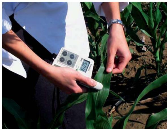
Figura 5. Fotografía del equipo medidor de clorofila SPAD®, mostrando su modo de uso.
