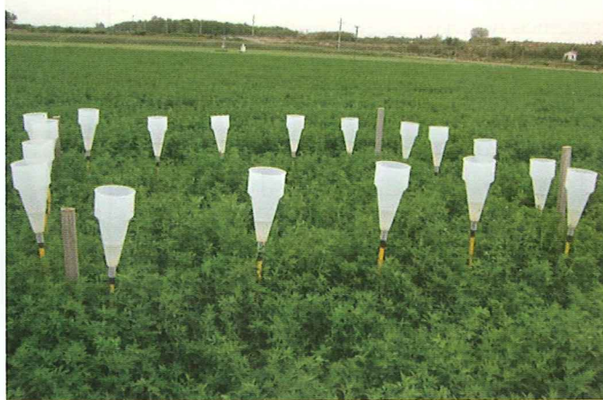
Fotografía 1. Pluviómetros instalados alrededor de uno de los lisímetros para determinar la dosis aplicada en los riegos de aspersión al lisímetro.
