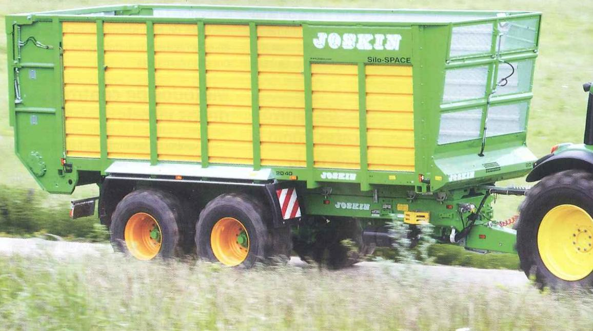
Suelo móvil hidráulico • Tren rodante flexible y ágil • Batiante frontal hidráulico • 4 modelos, capacidad hasta 55 m<sup>3</sup>
