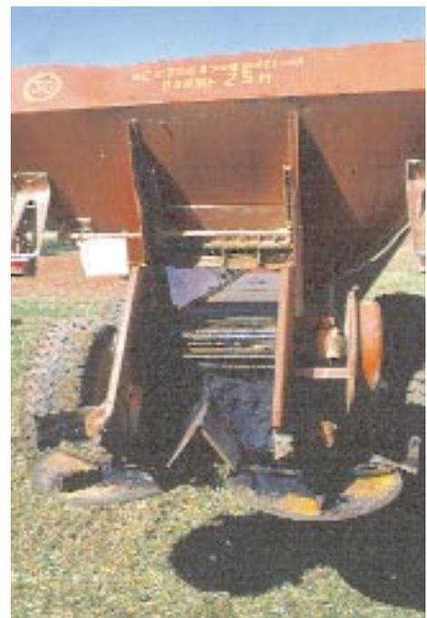
Figura 16. Esparcidor de compost de alto rendimiento en el campo. Se puede ver el fondo móvil y dos platos giratorios.
