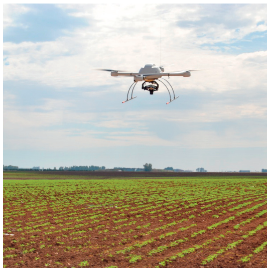
Figura 2. UAV MD4-1000 en vuelo sobre el campo de cultivo con la cámara visible acoplada en su parte central.
