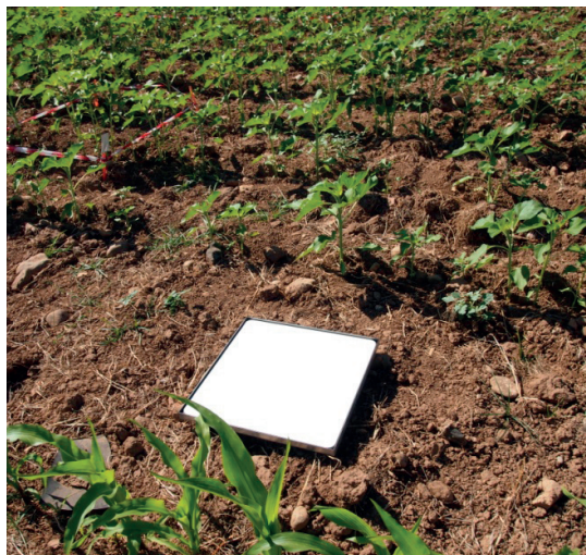
Figura 3. Detalle del panel espectralón sobre el campo de girasol.
