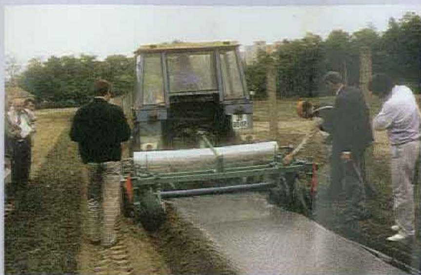
Figura 5. Mecanización del acolchado plástico.
