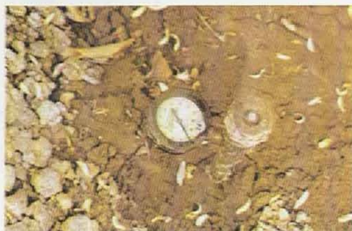
Tensiómetro situado en un bulbo saturado de humedad.
